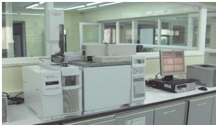
Şekil 2. Agilent 3 Dedektörlü GC (HP 6890 GC, \mu -ECD, Dual FPD, 5975 MSD) cihazı
