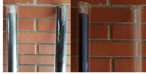
Şekil 4. Soldan sağa sırasıyla dıştan grafit, içten grafit kaplamalı tüpler, ticari tüp ve kaplamasız tüp görüntüleri
