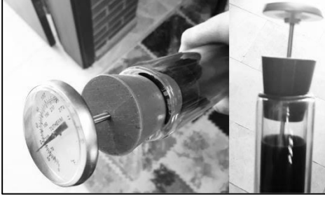
Şekil 2. Kaplaması yapılmış ve vakuma alınmış tüplerin sıcaklık ölçme düzeneği
