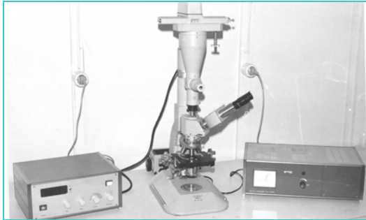
Resim XXXII-15,16. Tezlerin DNA ölçümlerinin yapıldığı mikroskop fotometre aygıtları, ilki Ege Üniv. Fen Fak. Botanik AD'da, diğeri ise Cumhuriyet Üniv. Tıp Fak. Patoloji AD'dadır.
